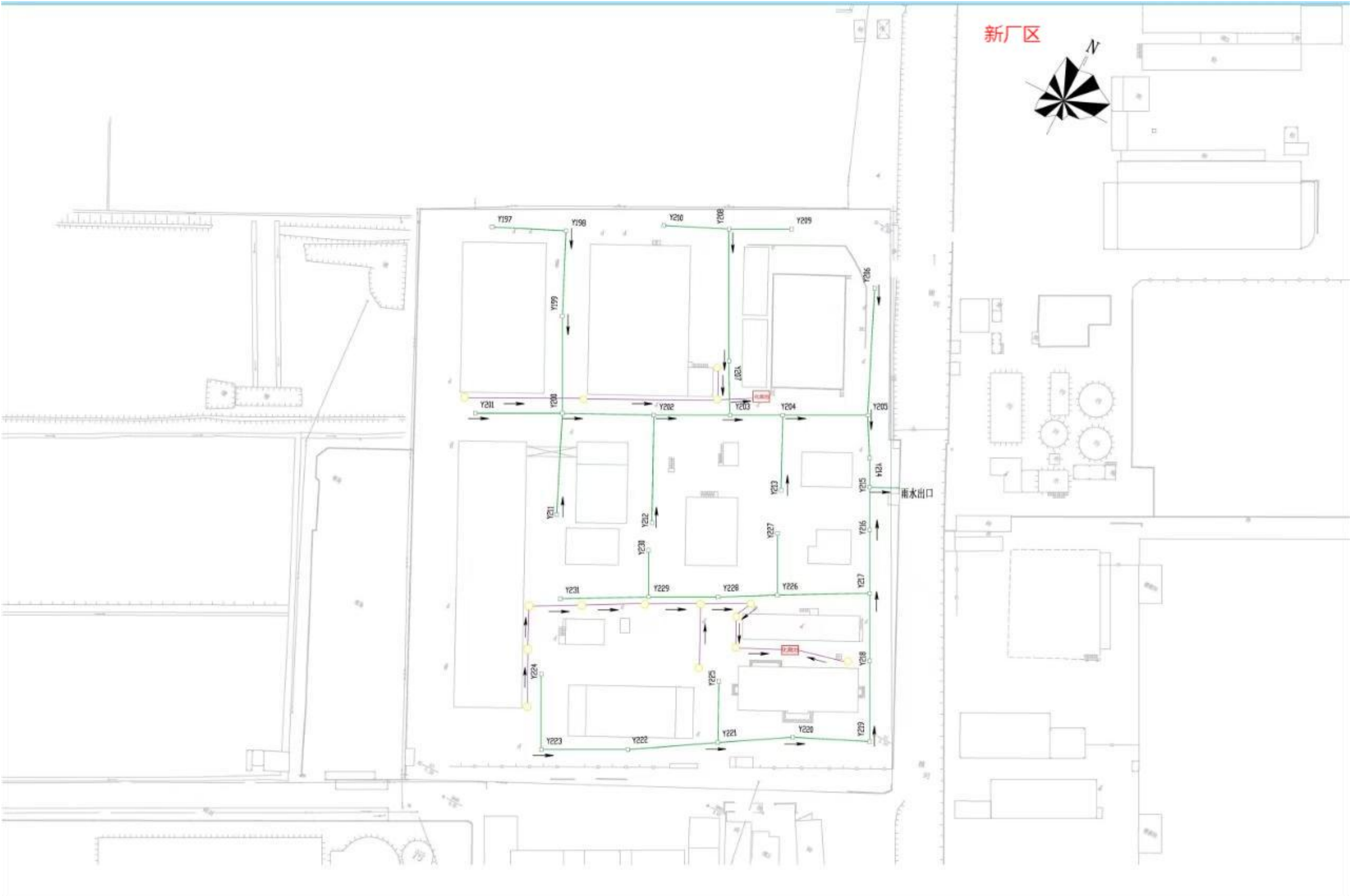
图 3.1-4 全厂雨水管网图
